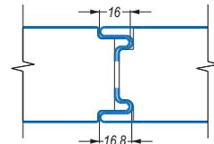
**ТСП с утеплителем МИНЕРАЛЬНАЯ ВАТА, облицовка внешней и внутренней стороны ЛКП**
